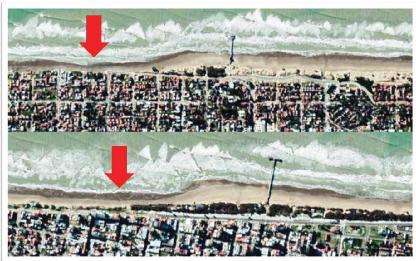
Figura 71. Frente costero de un sector de Mar del Tuyú (arriba) y Santa Teresita (abajo) donde se observa la modificación de la línea costera causada por los muelles de pesca. En estos casos, se comportan como una escollera, reteniendo sedimentos al sur, y provocando erosión hacia el norte. Las flechas rojas muestran las intrusiones marinas causadas por la pérdida de sedimento y disminución de las playas.
