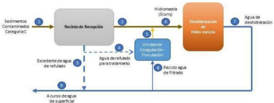
Figura 4. Diagrama de bloque simplificado del proceso de tratamiento de sedimentos contaminados
