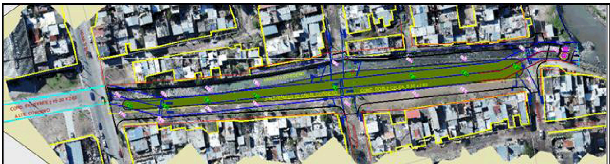
Figura 4: Planimetría de Obras Entubamiento Canal Calle Cordero.
