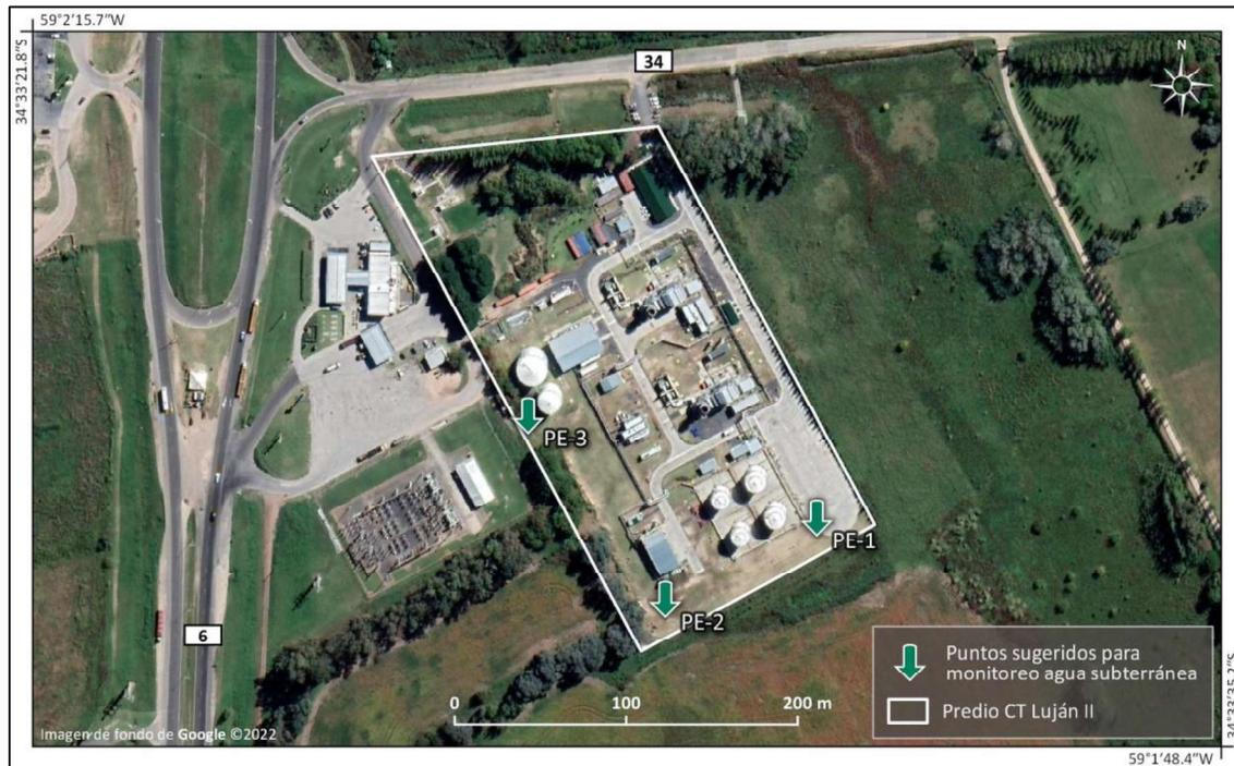
Figura 6-7. Puntos mínimos de muestreo sugeridos para monitoreo de Agua Subterránea.
