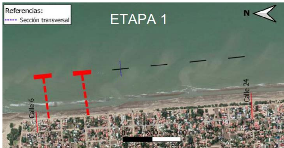
Figura 5. Metodología de construcción de espigones de acceso auxiliares. Etapa 1.
