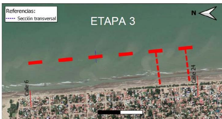
Figura 7. Metodología de construcción de espigones de acceso auxiliares. Etapa 3.
