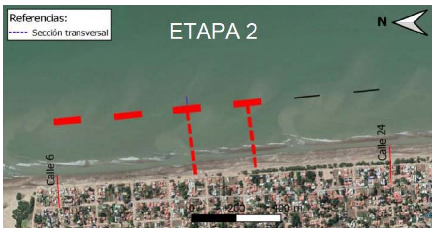
Figura 6. Metodología de construcción de espigones de acceso auxiliares. Etapa 2.
